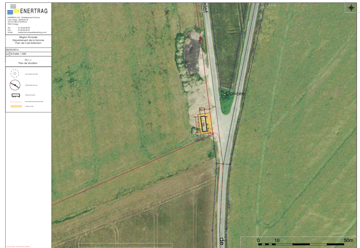
FIGURE 63 : IMPLANTATION DU POSTE DE LIVRAISON 1
